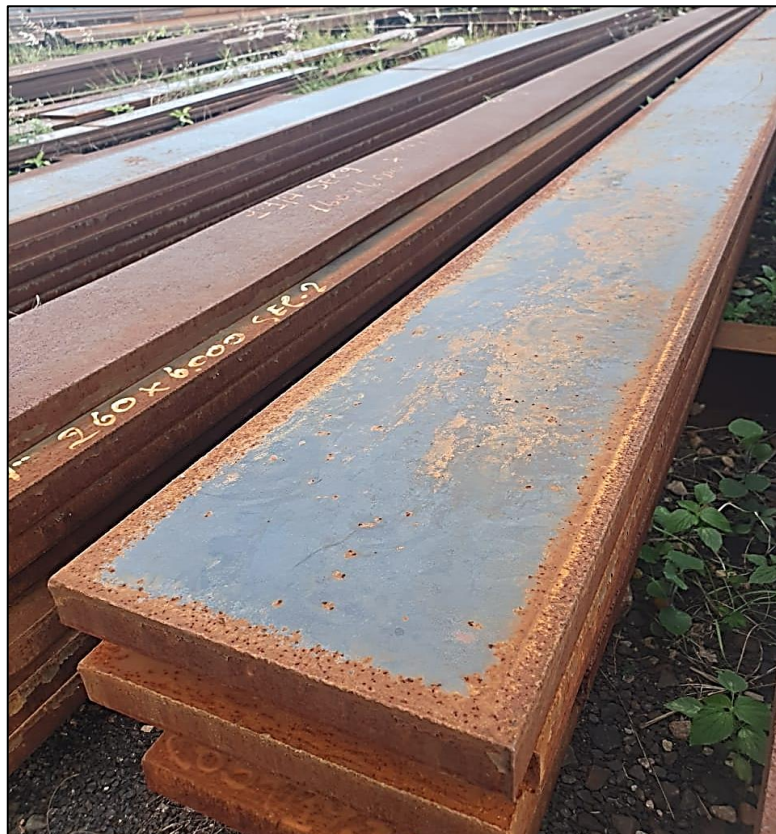
Figura 2: Perfil (barra chata) sob efeito corrosivo.
