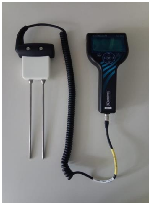
Figura 1: Sensor de umidade do solo HydroSense II (Foto: L. H. Bassoi)
