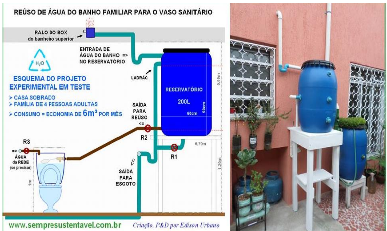
Figura 8 – Proposta de reúso de água de banho na descarga de vaso sanitário por gravidade.
