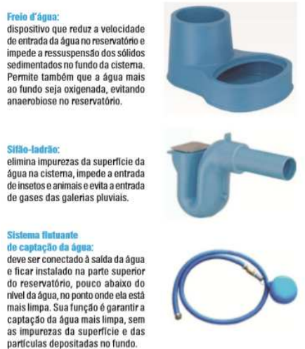
Figura 10 - Componentes do reservatório
