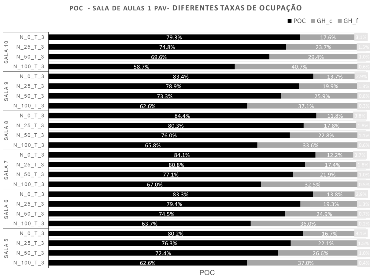
Figura 4-9 - Avaliação POC - ASHRAE 55 30 dias anteriores, para salas do primeiro pavimento com diferentes porcentagens de cargas térmicas internas.
