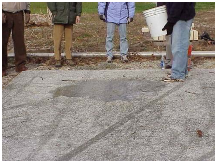
Figura 9 - Pavimento em concreto poroso e sua demonstração de poder de infiltração.
