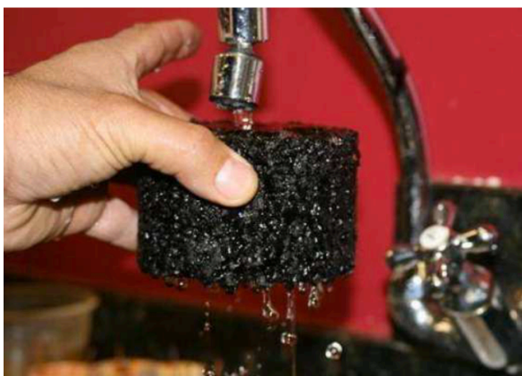
Figura 7 - Demonstração da permeabilidade da CPA
