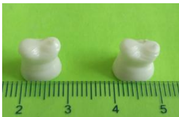
Figura 7: Impressão 3D de coroa de zircônia após a sinterização
