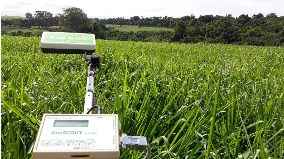
Imagem 1. – Sensor de reflectância e Datalogger utilizados em campo.
