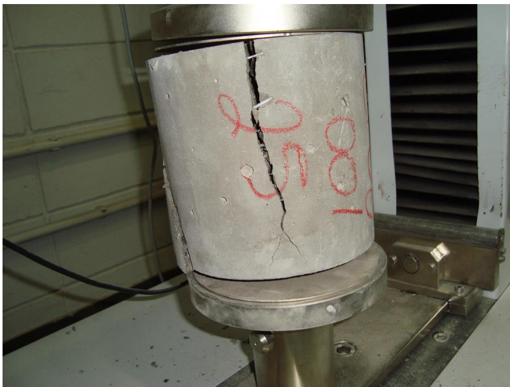
Figura 17: Corpo de prova 01-25-04 após o ensaio de duplo puncionamento
