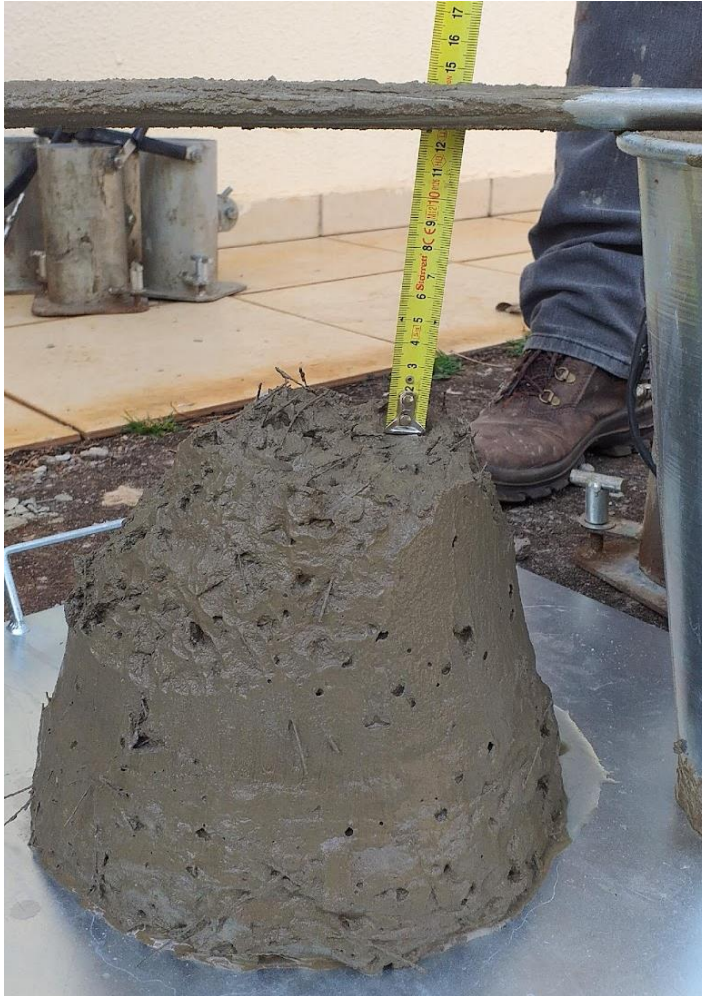
Figura 5: Slump test do concreto reforçado com fibras.
