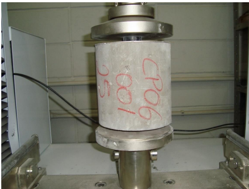
Figura 7: Corpo de prova 2/5F posicionado na prensa, para determinação das resistências à fissuração e residuais à tração
