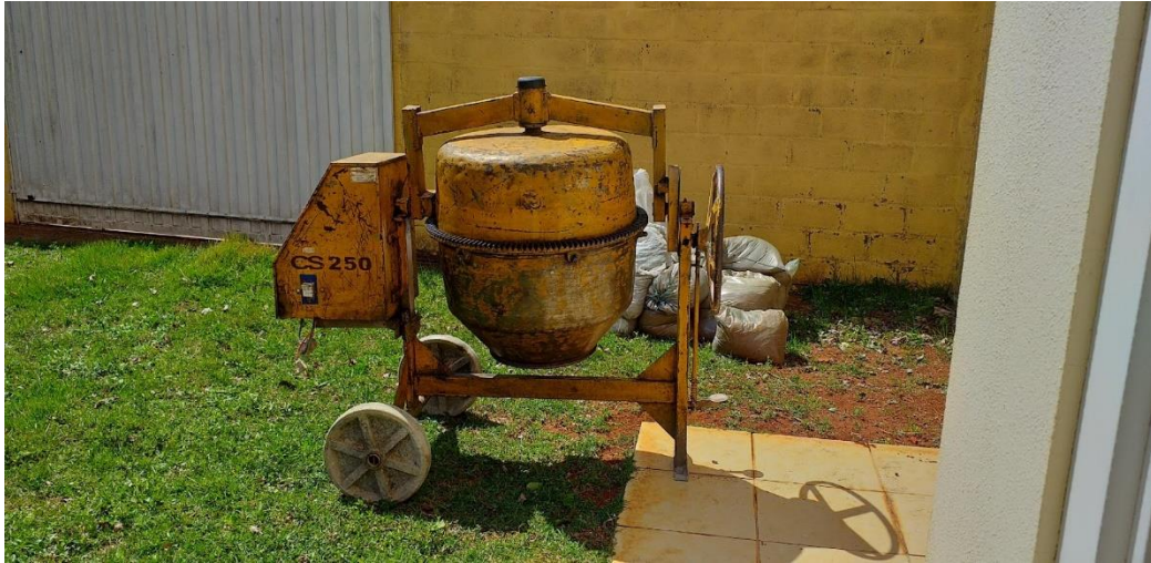
Figura 3: Betoneira CSM 250 litros.
