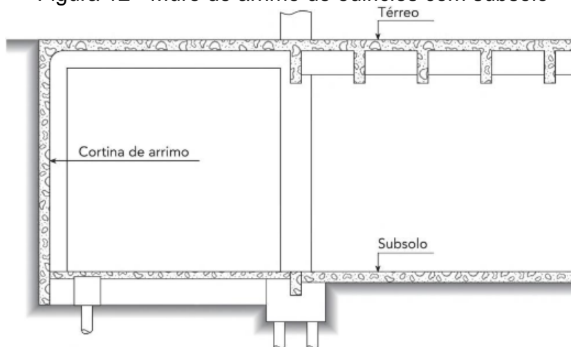
Figura 12 - Muro de arrimo de edifícios com subsolo
