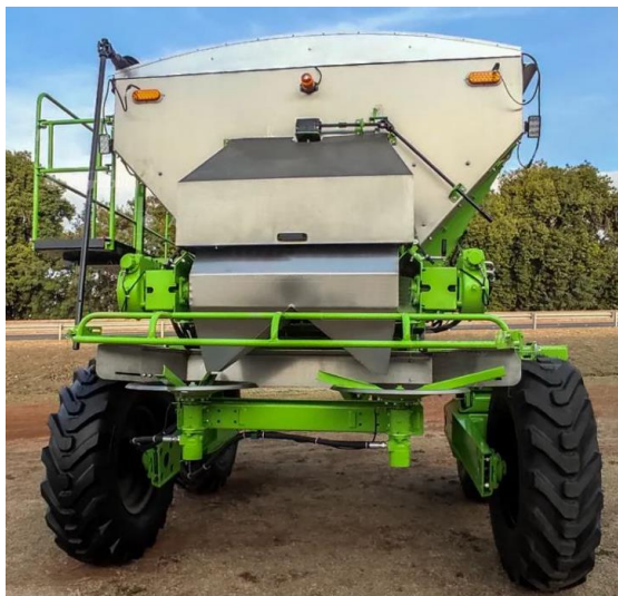
Figura 4: Parte posterior do distribuidor centrífugo Piccin Master 15000 Full tech.
