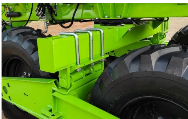
Figura 2: Célula de carga do distribuidor centrífugo Piccin Master 15000 Full tech em ângulo lateral.
