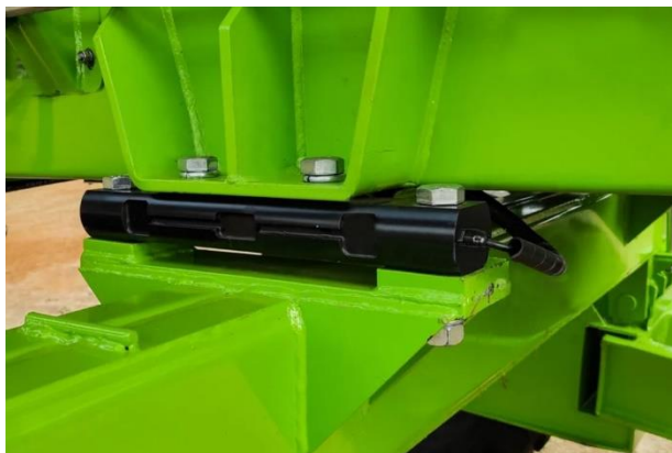
Figura 3: Célula de carga do distribuidor centrífugo Piccin Master 15000 Full tech em ângulo frontal.
